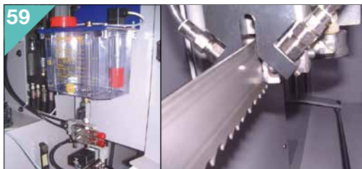
Impianto per lubrificazione minimale. Minimal lubrication system.
