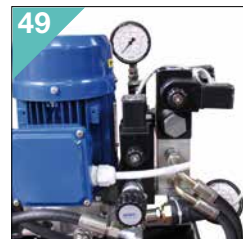
Un riduttore di pressione per morsa idraulica. One pressure reducer for hydraulic vice.
