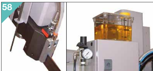
Impianto per lubrificazione minimale. Minimal lubrication system.
