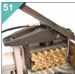
Dispositivo oleodinamico per taglio a fascio. Hydraulic device for bundle cutting.
